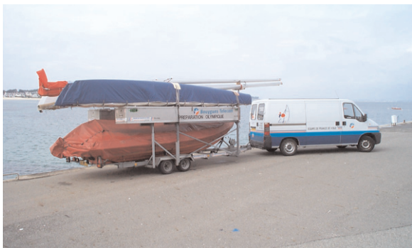
Le taud de route en PVC absolument nécessaire pour la préservation des tubes du semi-rigide par rapport au gasoil.
