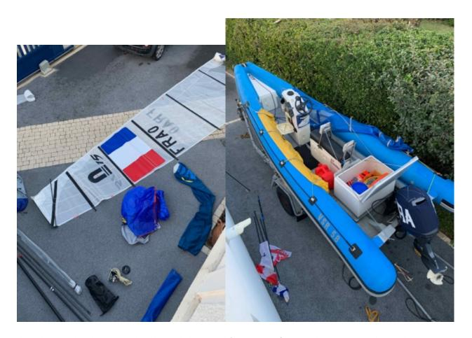
Il y a donc 1 palan de GV, 2 sticks, 1 barre de liaison, 1 bôme, 1 spi, 1 foc, 1GV de « spare » ou de remplacement en cas d'avarie.
