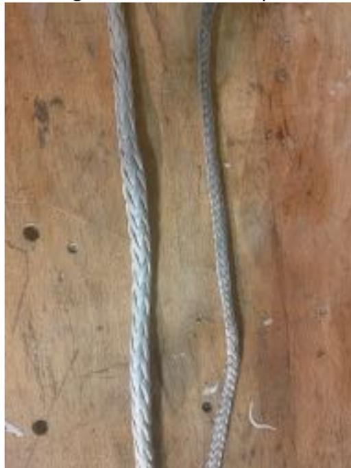
**ÂME PARALLÈLE** : on élimine le phénomène de pompage en plaçant les fibres dans le sens de la traction : le cordage est donc plus raide à la traction. Principalement utilisé pour le gréement dormant. Mais impossible à épisser et nécessitant des terminaisons particulières.
