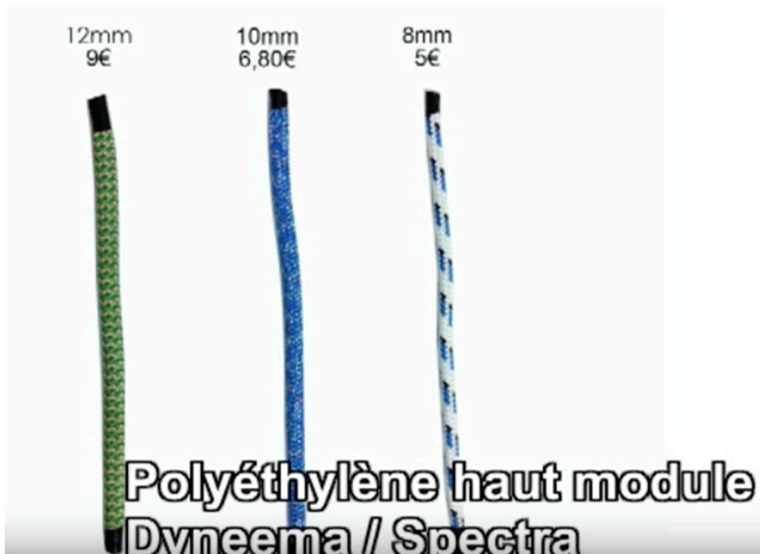
Pour le reconnaître : en le brûlant il se rétracte en s'évasant, les fibres ne se soudent pas. Et il flotte.
