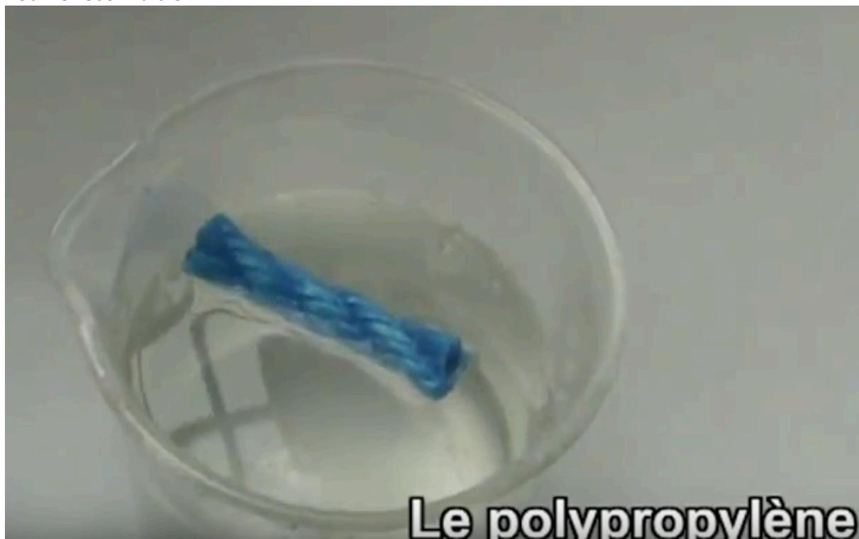
Léger, élastique, hydrophobe et flottant, il est souvent utilisé en bout de remorquage.
