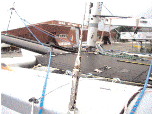
Vue d'un stamaster : cadène à vis qui sert au réglage de la tension du haubannage
