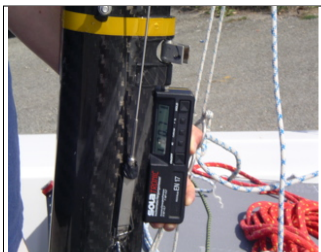
Inclinomètre positionné sur mât
