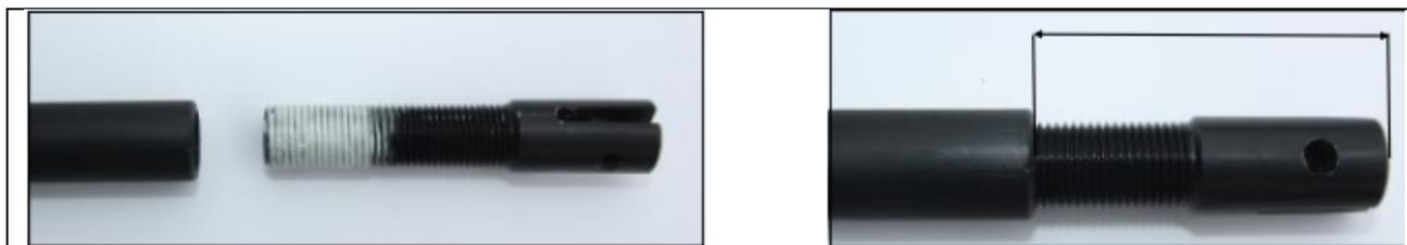
**Les embouts de barre de flèche se devise ou se visse pour en régler l'angle, n'oublie pas de graisser !**
