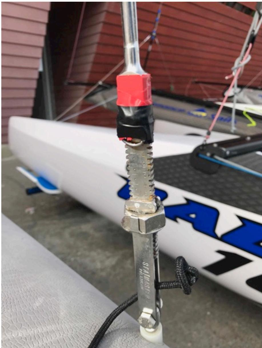
Si tu dois acquérir un tensiomètre je te conseille d'acquérir le tensiomètre **Rig Sense de Spinlock : le tensiomètre pour gréement dormant**
