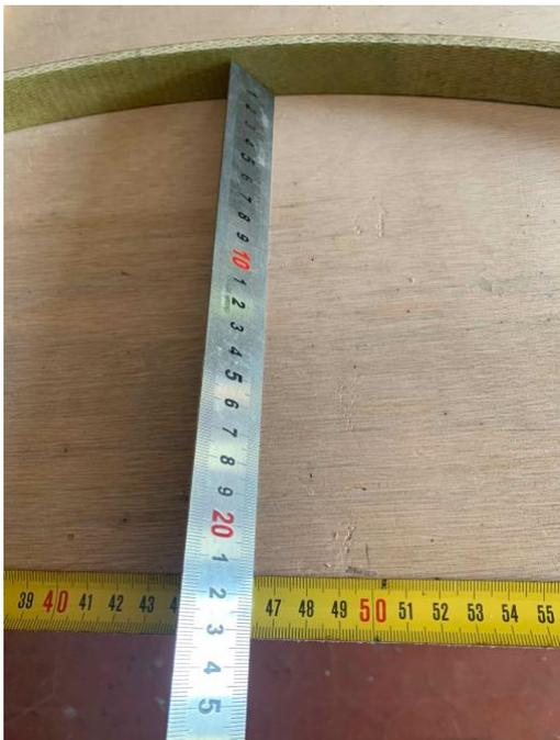
A l'aide d'une pige ou d'un réglet on cherche la position du creux max en veillant à maintenir la pige ou le réglet bien perpendiculaire au mètre ruban.
