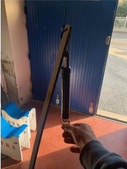
Un pèse poisson permet de mesurer la raideur et de l'exprimer en kilo :
