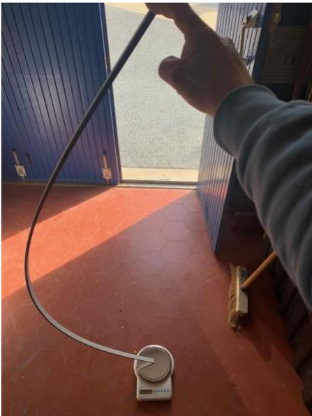
Une balance de cuisine fait aussi l'affaire : on contraint la latte en exerçant une pression verticale, on voit les chiffres de la balance augmenter au fur et mesure de la contrainte, puis les chiffres se stabilisent même si on exerce une pression de plus en plus forte. C'est le bon moment pour noter la valeur
